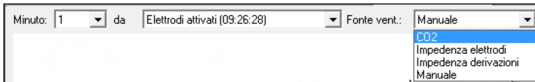
**CO2:** il sistema annota automaticamente i contrassegni della ventilazione basata su CO2 quando i dati sulla CO2 contengono informazioni sulla rilevazione del respiro.
