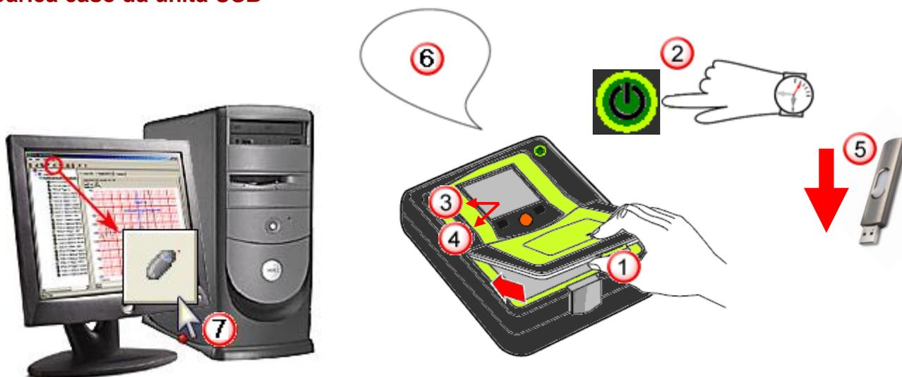
1. Rimuovere il coperchio delle batterie dalla parte superiore di AED Pro rilasciando il fermo anteriore e sollevandolo sul coperchio.
