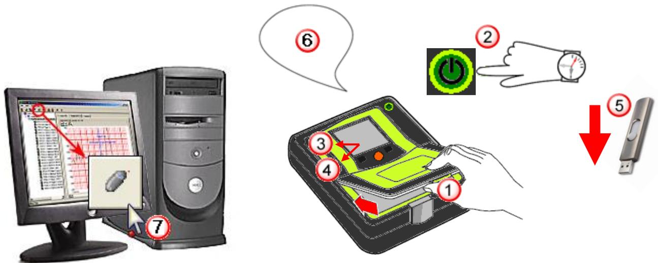
1. Extraiga la tapa de la batería de la parte superior de AED Pro soltando el seguro frontal y levantando la tapa.
