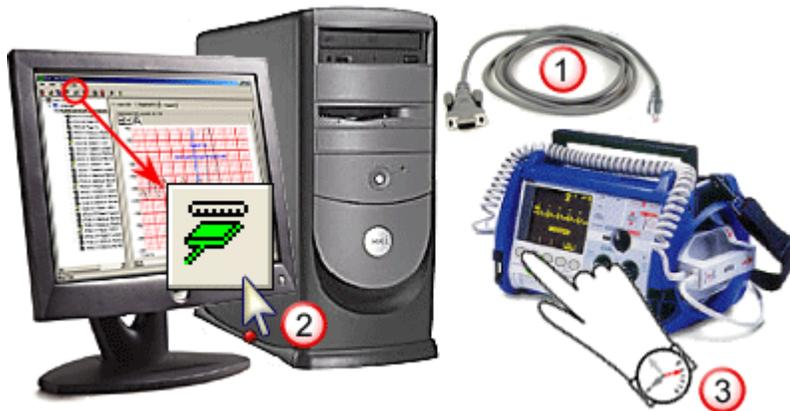
1. Conecte el desfibrilador al puerto serie de la estación de trabajo de RescueNet Code Review. Para M Series/E Series, debe utilizar el cable de transferencia de datos ZOLL RS-232 (número de pieza ZOLL 8000-0605-01), que termina en un conector DB9 hembra. Para 1600/1700, debe utilizar un cable de enlace en serie y conector ZOLL 1600 (número de pieza ZOLL 8000-1614).
