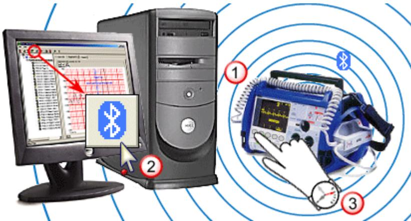
1. Coloque el desfibrilador cerca de una estación de trabajo de RescueNet Code Review activada para Bluetooth (el Bluetooth es omnidireccional y tiene un alcance comprendido entre 6 y 9 metros).
